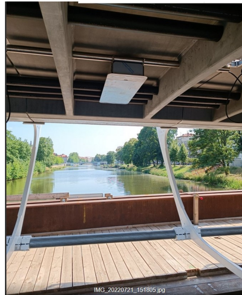
Obr. 9 a 10 Umístění čidel hydrostatické nivelace pod mostovkou
