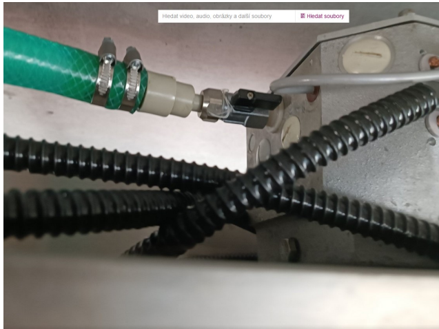
Obr. 9 a 10 Umístění čidel hydrostatické nivelace pod mostovkou
